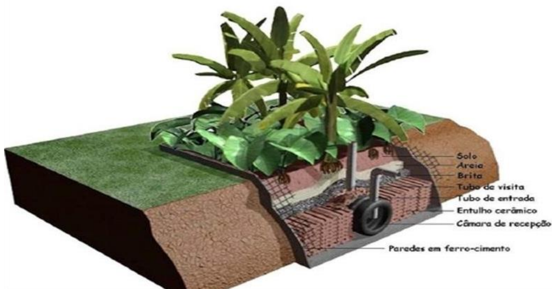
Figura 1. Tanque de Evapotranspiração e suas camadas. (Fonte: GALBIATI, 2009)
